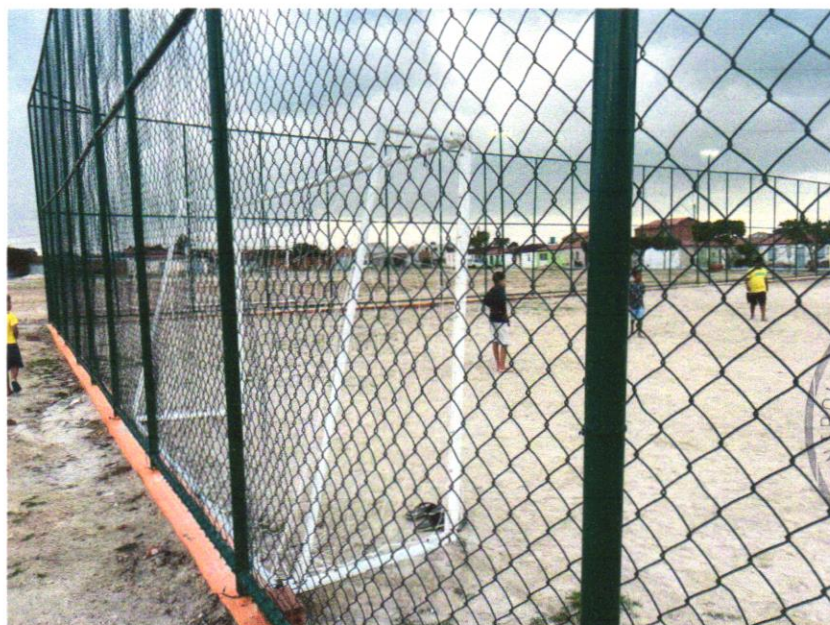
Foto 06 – Traves oficial para futebol de salão 3x2m em aço galv.3", com requadro e redes de polietileno fio 4mm (conjunto p/futsal)
